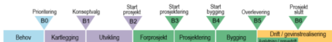
Figur 1: Prosjektmodellen med faser og beslutningspunkter
