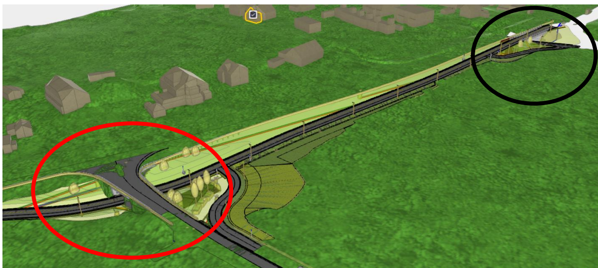
Figur 1 Utsnitt fra modell viser kulvert i sør med kulvert under Myklabergveien (rød ring) og bru i nord (sort ring).
