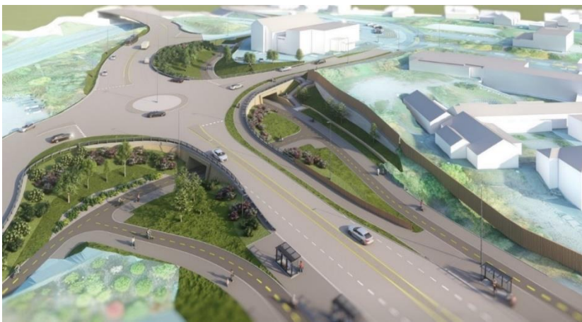
Figur 1: Oversiktsbilde nytt kryss på Stangeland, to nye kulverter for myke trafikanter, ny sykkelløsning fra sykkelstamvegen og øverste del av Oalsgata.
